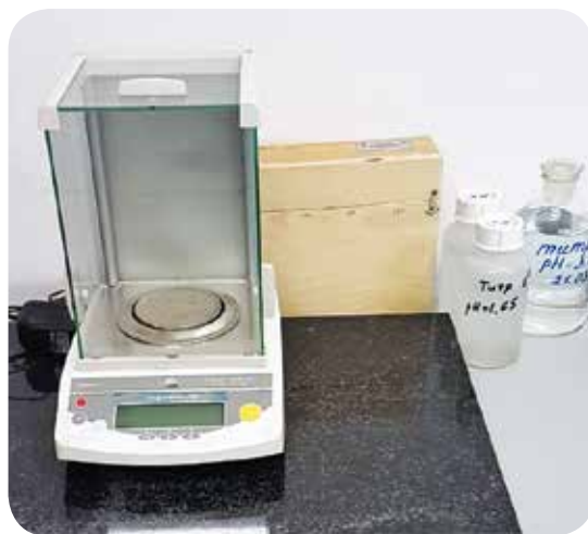
Аналитические весы с гранитной плитой для гашения вибрации
