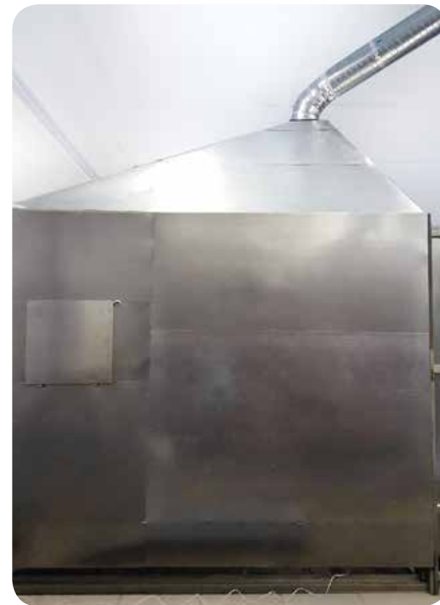
Огневой бокс для проверки качества пенообразователя
