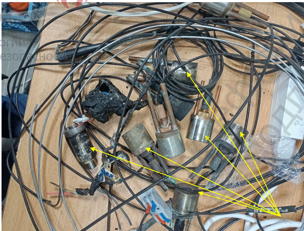
Рисунок 5.1 - Датчики ДРТП-15, вышедшие из строя после испытаний (отмечены стрелками желтого цвета)
