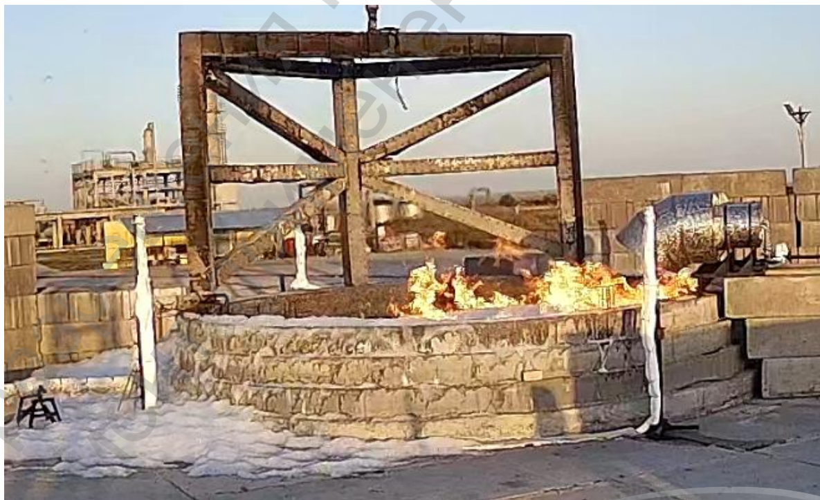
Рисунок 5 - Горение паров СПГ после прекращения подачи ВМП типа «Аквафом» - ПНСВ-3%, с рабочей концентрацией 3 %
