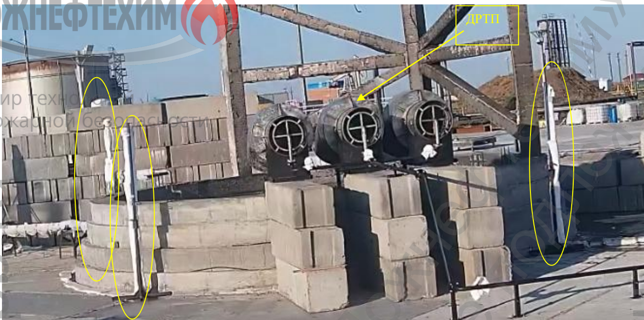
Рисунок 3.3 - Расположение датчиков теплового потока (ДТП) на удалении 1,5 м от модельного очага №4 и на высоте 0,75 м и 1,5 м от уровня площадки для испытания №1-3 (24.09.2025-26.09.2025).
