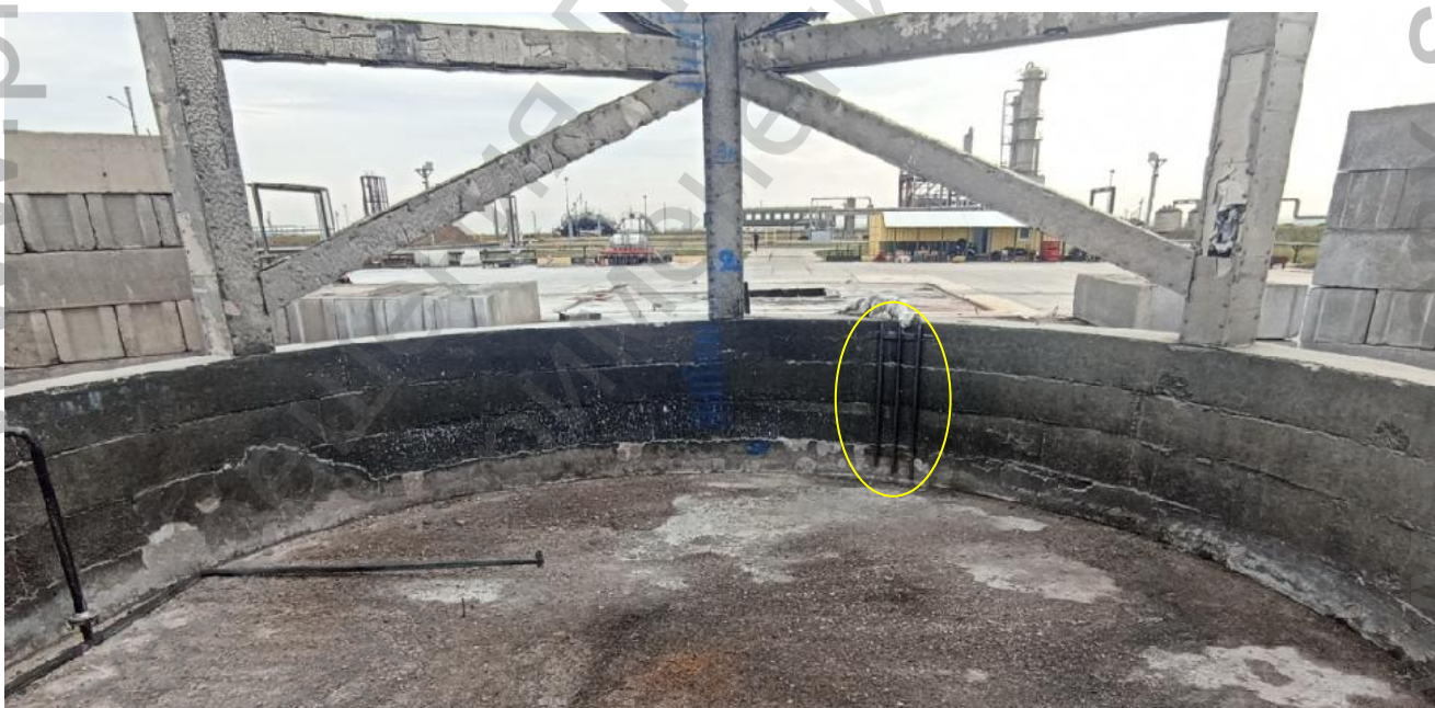
Рисунок 3.4 – Расположение датчиков температуры в модельном очаге №4 по высоте на уровне 0,05 м, 0,1 м, 0,15 м от днища модельного очага
